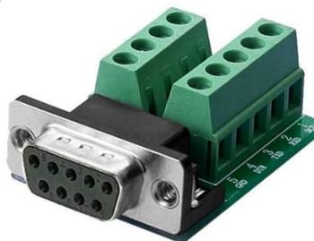
E' arrivato addirittura in un giorno: aggiuntovi un microswitch per commutare l'eventuale scelta DTR o RTS per comandare il PTT (vedi il funzionamento del programma di decodifica RTTY MMTTY ), qualche filo e collegare il tutto all'altro cavo necessario come adattatore fra il plug microfonico dello Yaesu e il mio "standard" più congeniale è stato un tutt'uno ed ero pronto ad andare in aria, con l'817 e la windom di casa.
